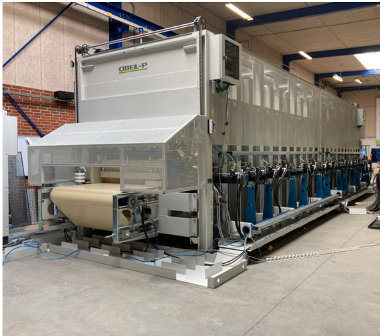
Pressen in XXL: Die neueste HF-Brettschichtholz-Pressen hat ein Pressbett von 10.500 mm Länge
